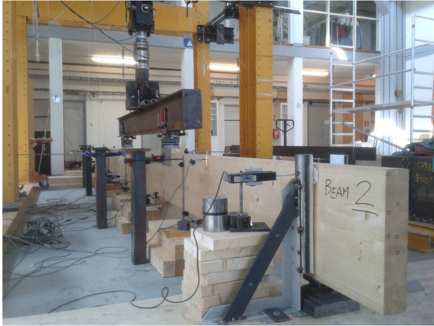
Figur 1. Laboratorieförsök av slanka limträbalkar.
